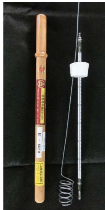
測定に用いた温度計、ケース および攪拌棒 ※温度計: 二重管標準温度計0号 目盛り= +2~-56°C
