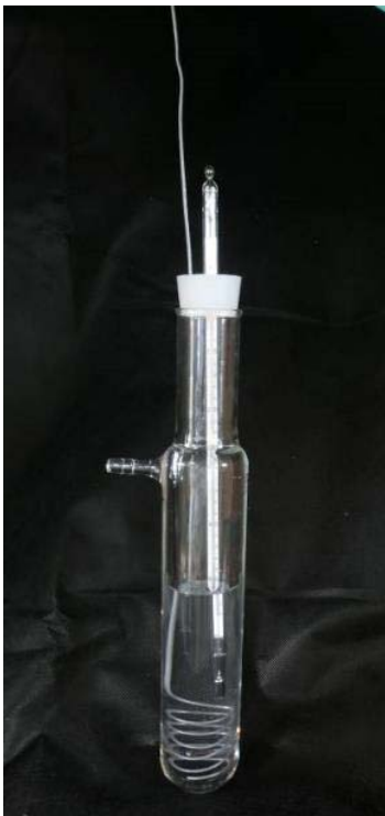
-40°C の外観 (WATER SHIELDは クリアーで凍結なし) 【凍結管に試験液を入れ 温度計、攪拌棒を設置した状態】
